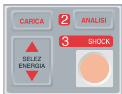
Selezione energia sul pannello anteriore
